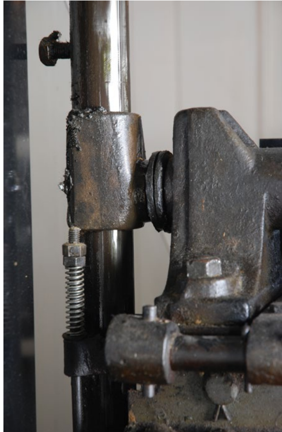
Le parachute: mis au point dès 1853 par Otis, ce système de sécurité empêche la chute de la cabine en cas de rupture de câble.
