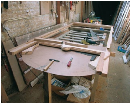
Copie de châssis ancien en cours de réalisation en atelier.
