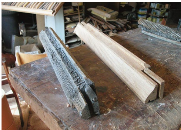
Reproduction à l'identique d'une pièce (jet d'eau) à remplacer.
