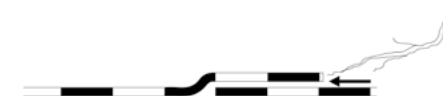
Risque de pénétration des racines au droit des recouvrements des bandes d'étanchéité © NIT 229 CSTC
