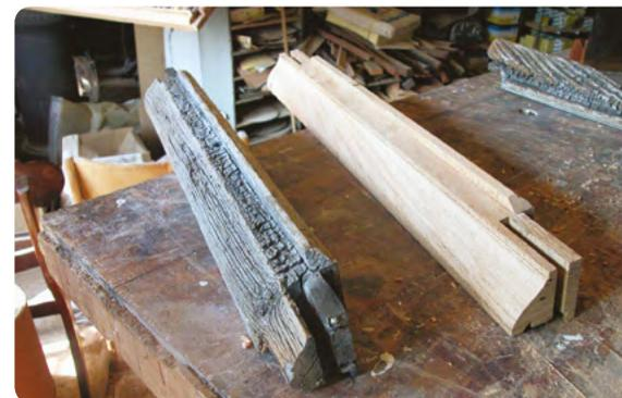
Reproduction à l'identique d'une pièce (jet d'eau) à remplacer
