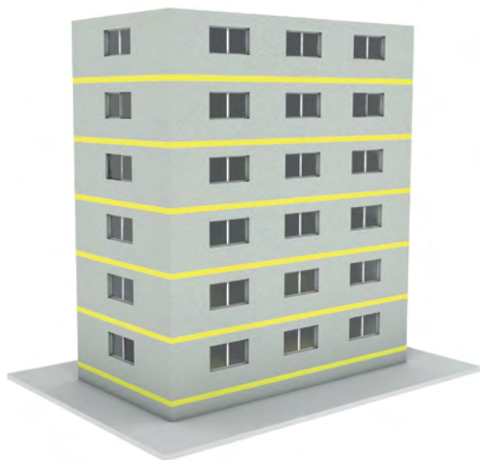
Aanbeveling voor een gebouw van gemiddelde hoogte : stroken uit rotswol van 200 mm hoog aan de gevelvoet en per bouwlaag © CSTC
