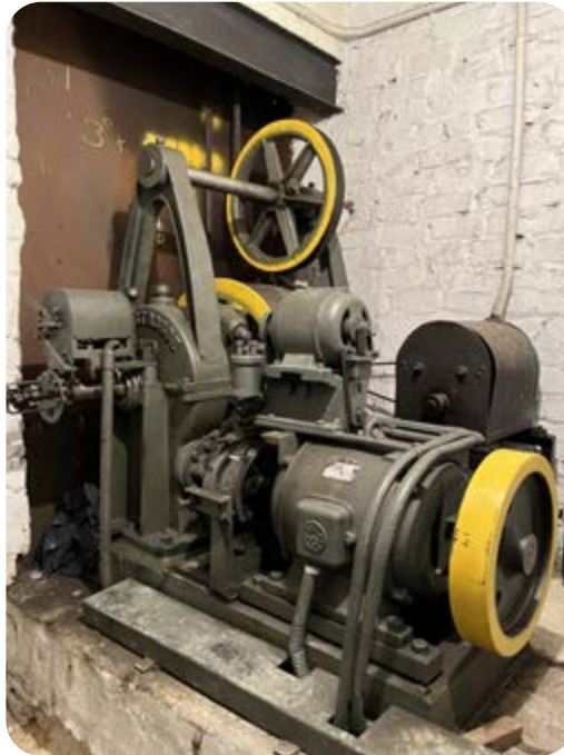
Verven van de kabeltrommel, het afleidwiel en het vliegwielt voor handbediening
