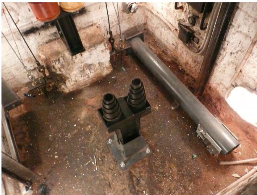
Stopinrichting van de kooi op de bodem van de schacht
