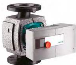
Plus économe en énergie, ce circulateur module sa vitesse pour que la pression reste constante, quelle que soit la demande de chauffage. Son achat est rapidement amorti car la consommation électrique évolue exponentiellement en fonction de la vitesse : une vitesse réduite de moitié, c'est une consommation électrique divisée par 8 !
