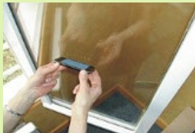
Figure 37 : Vitromètres - les cercles tangents indiquent l'épaisseur du verre (sources : Energy+ et Prismaver)
