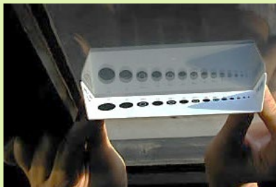
Figure 37 : Vitromètres - les cercles tangents indiquent l'épaisseur du verre (sources : Energy+ et Prismaver)
