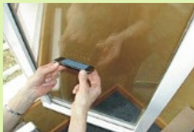
Figuur 28 : Vitrometers - de raakcirkels geven de glasdiktes aan (sources : Energy+ et Prismaver)
