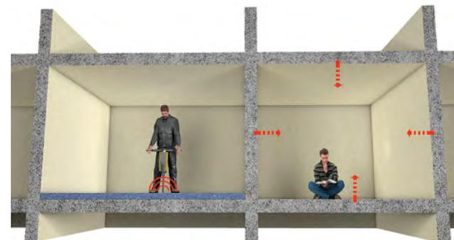
On supprime le contact rigide en interposant un matériau souple (amortissant ou de désolidarisation) entre la source d'émission du bruit et le bâtiment. Concrètement, cela se traduit par la réalisation d'un **plancher flottant**.
