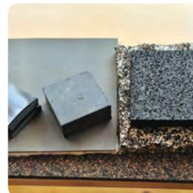
Elastomère et caoutchouc recyclé
