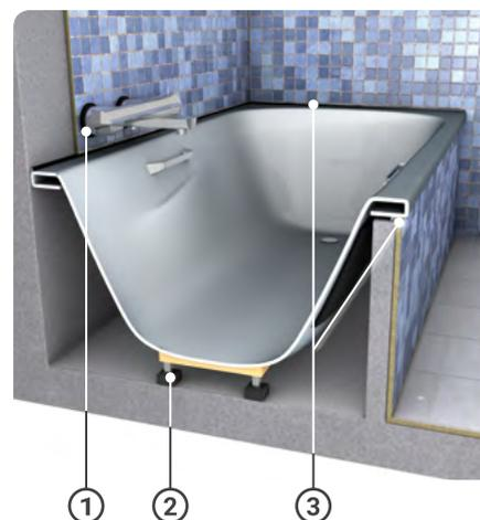
Pour éviter la transmission des bruits par contact, posez les lavabos, douches et baignoires sur des rondelles de caoutchouc ou des plots antivibratiles, et interposez un joint en silicone entre l'appareil sanitaire et le carrelage.
